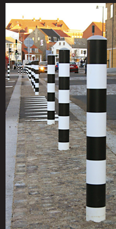
Flexys LightTower pullert med indbygget LED-lys
